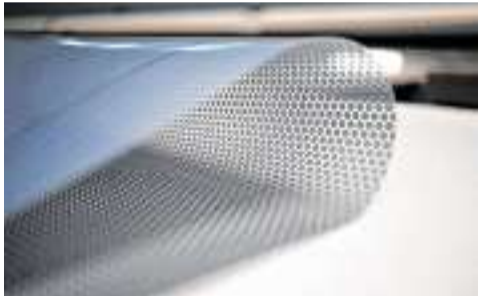
Aus den Folien werden Kissen hergestellt, die selbst Stadien überspannen.
